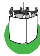
**Ne jamais rassembler en un point plusieurs sangles de préhension afin de manipuler un FIBC à moins qu'il soit expressément conçu par le fabricant pour une telle méthode de manutention.**
