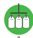
Dans le cas où il est possible de suspendre le sac en un seul point de levage, il est important d'assurer que les anses soient le plus vertical possible, moyennant des accessoires d'extension si ceux-ci s'avèrent nécessaires, de sorte à éviter les tensions latérales endommageantes.
